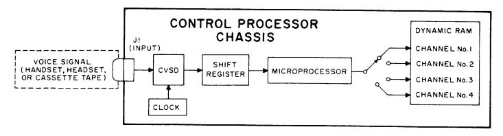
Fig. 2 - RECORD Mode Block Diagram
