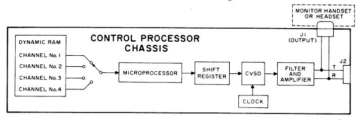
Fig. 3 - PLAYBACK Mode Block Diagram
