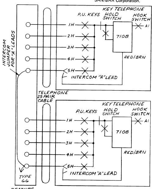
FEATURE REQUIRED CONNECTIONS FOR BLOCK EXCLUSION ON INTERCOM LINE
