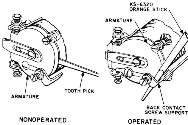
Fig. 16—Blocking 114-, 124-, 126-, 174-, and 198-Type Relays
