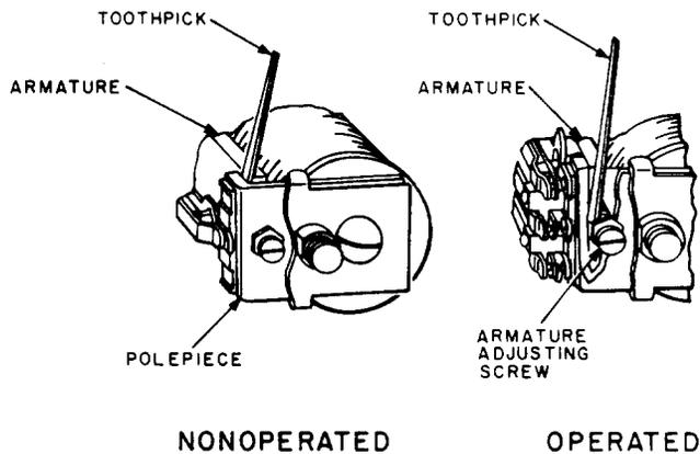
Fig. 15—Blocking 111-, 121-, 122-, 125-, 149-, 162-, 178-, and 179-Type Relays
