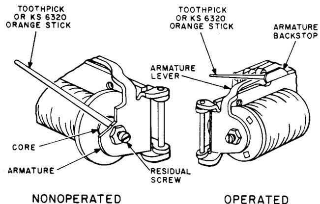
Fig. 22—Blocking 221-, 222-, 223-, 224-, 225-, 247-, and 248-Type Relays
