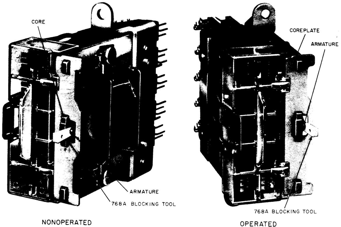
Fig. 10—Blocking 286-, 287-, and 288-Type Relays
