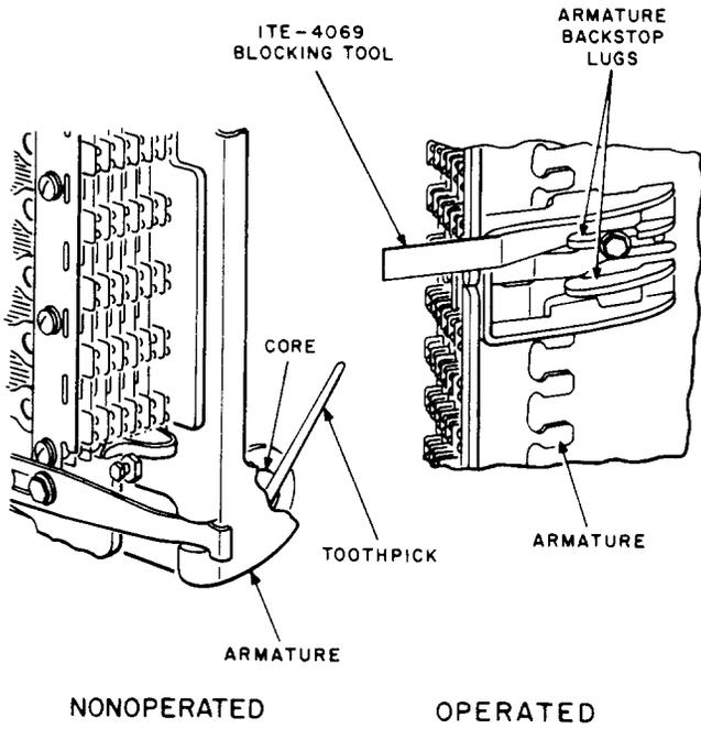
Fig. 25—Blocking 245-, 254-, 263-, and 264-Type Relays
