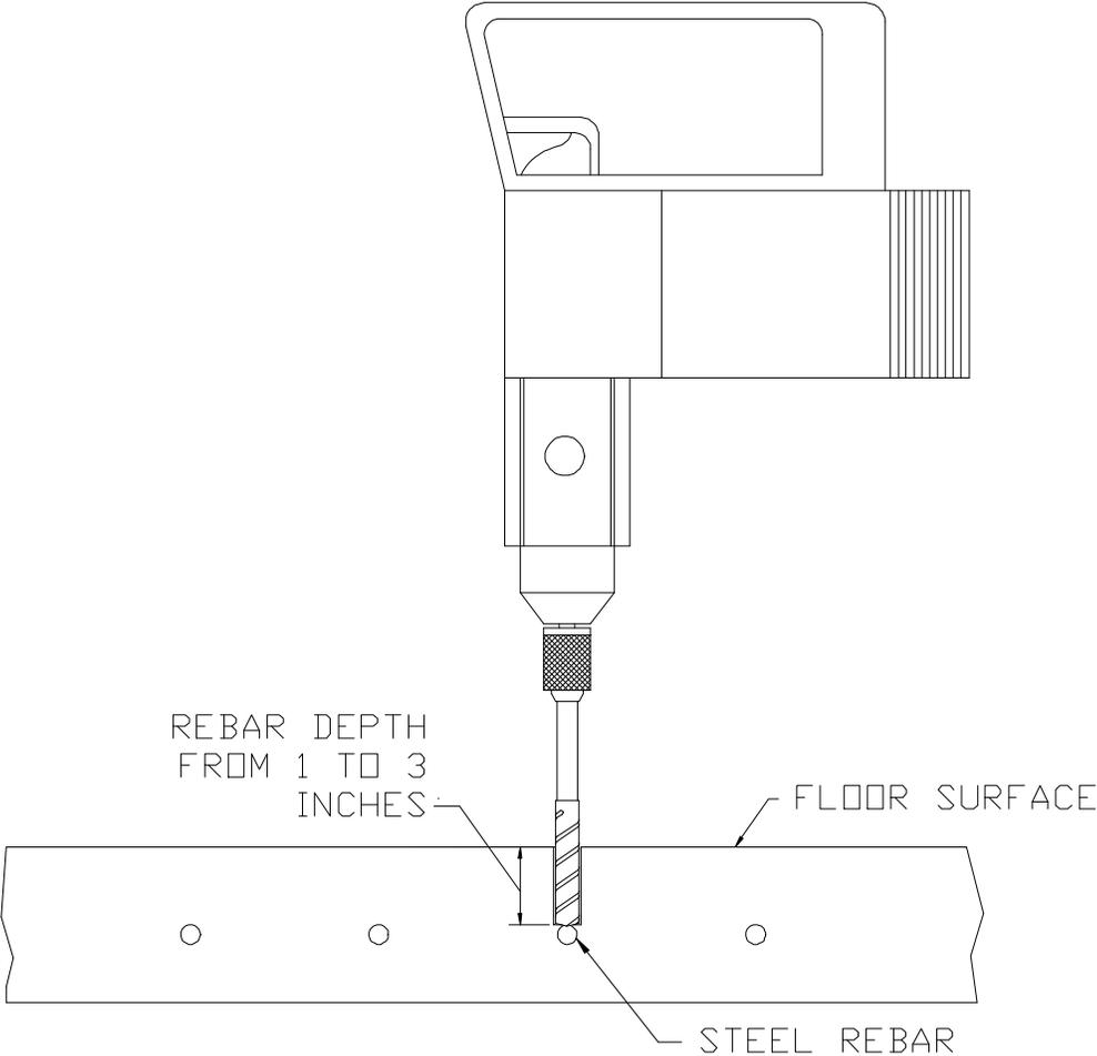
DRILLING OPERATION INTERFERENCE
