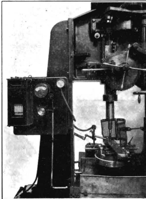
FIG. 2—TESTING MACHINE FOR LARGE DRILLS
