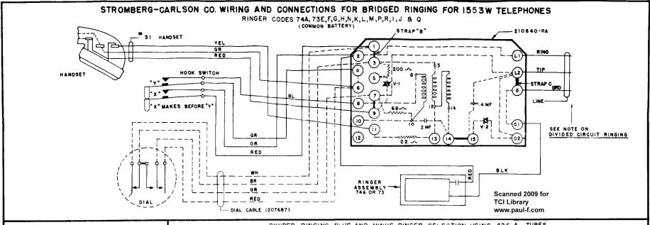
DIVIDED CIRCUIT RINGING FOR DIVIDED CIRCUIT RINGING CONNECT LINE AS SHOWN.
