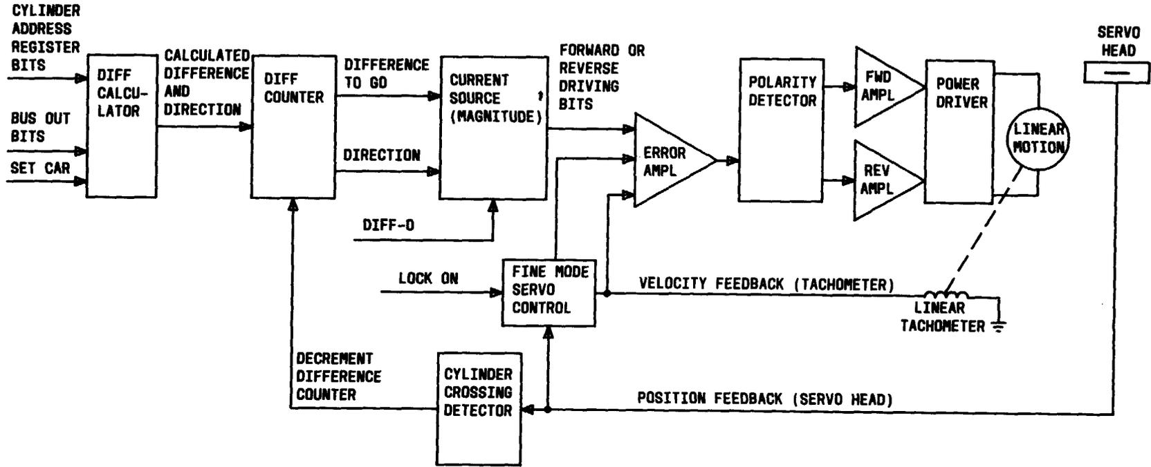
Fig. 11—Basic Servo Block Diagram
