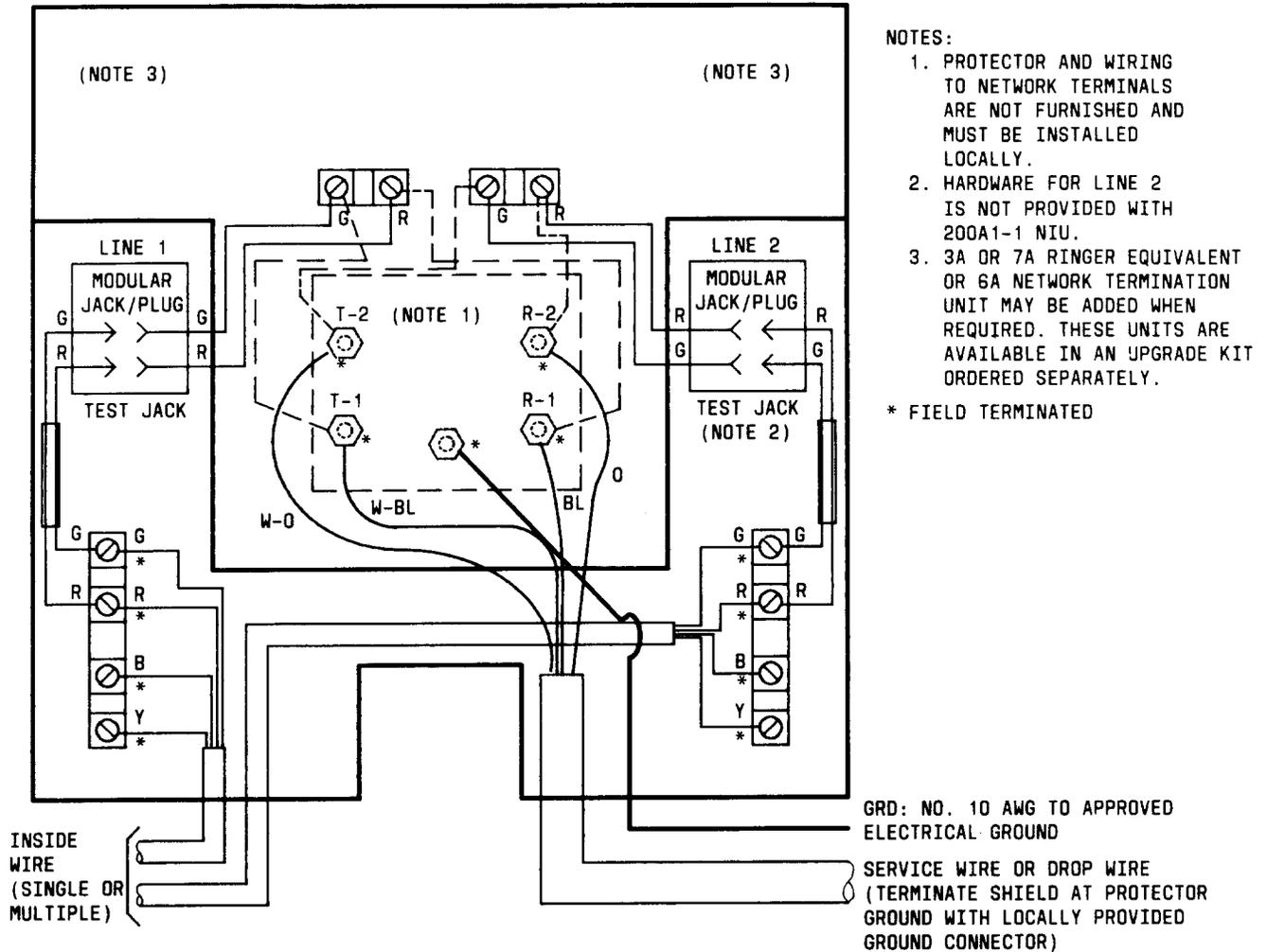
Fig. 3—200A1-1 and 200A2-2 NIU—Wiring Diagram
