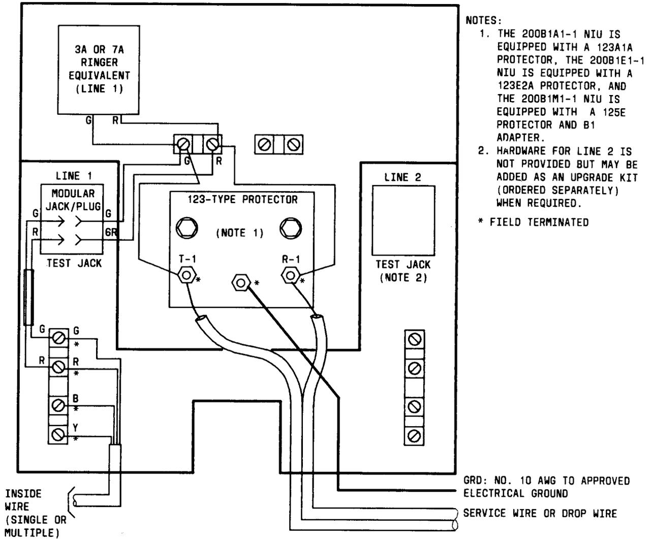
Fig. 7—200B1A1-1, 200B1E1-1, and 200B1M1-1 NIU—Wiring Diagram
