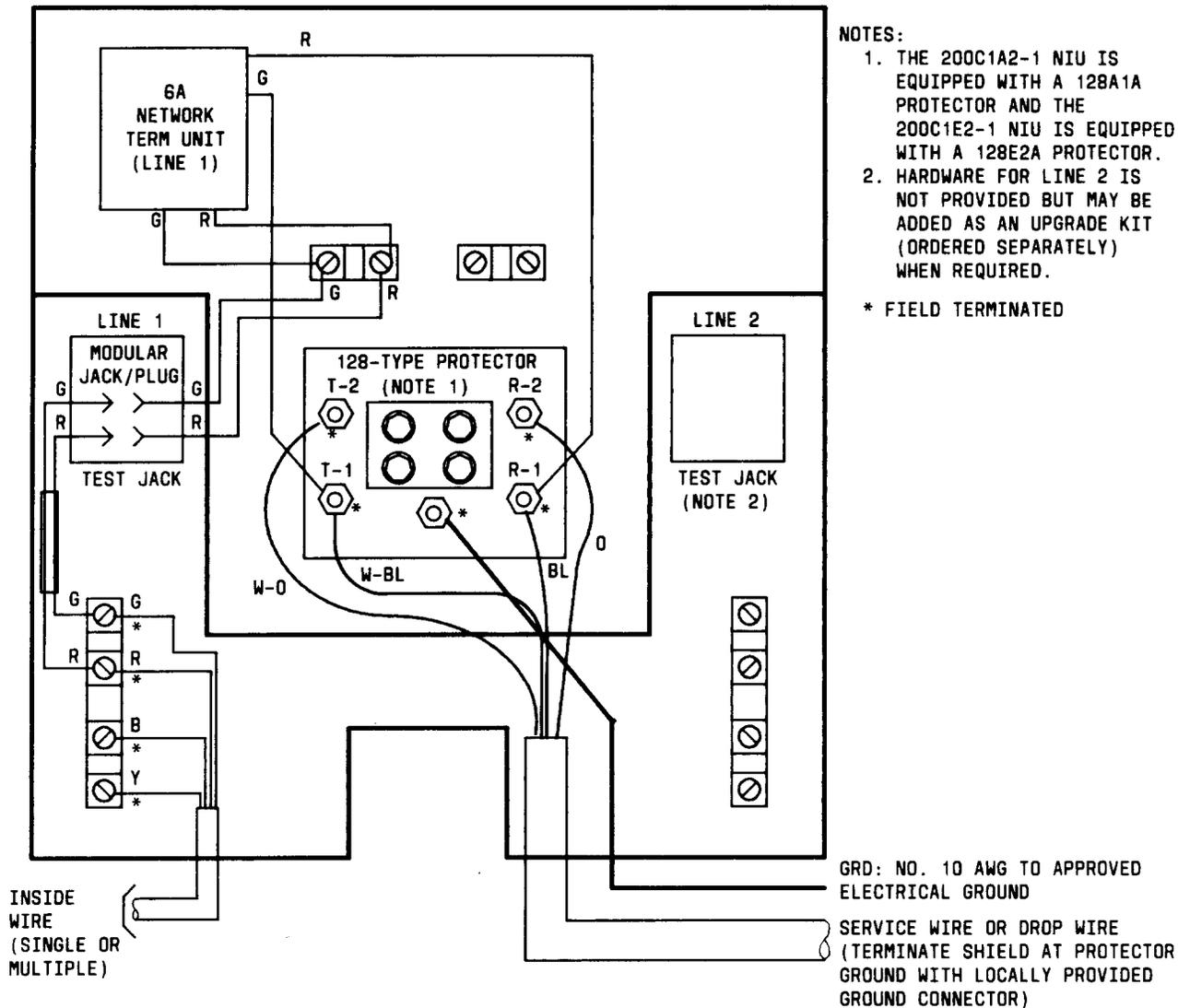
Fig. 12—200C1A2-1 and 200C1E2-1 NIU—Wiring Diagram
