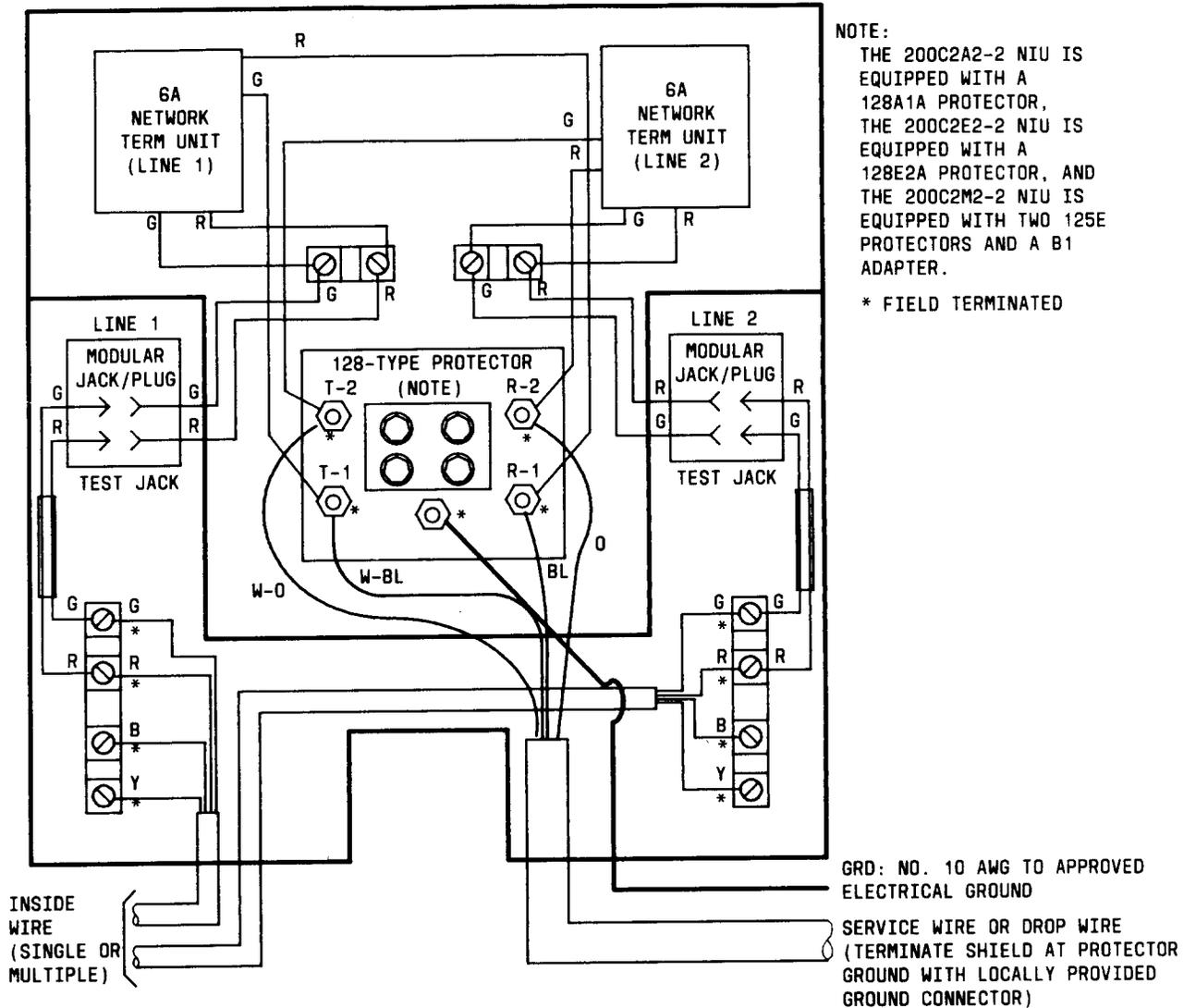
Fig. 13—200C2A2-2, 200C2E2-2, and 200C2M2-2 NIU—Wiring Diagram
