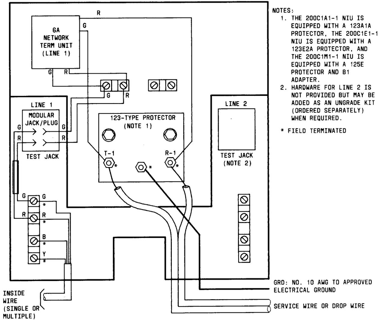
Fig. 11—200C1A1-1, 200C1E1-1, and 200C1M1-1 NIU—Wiring Diagram
