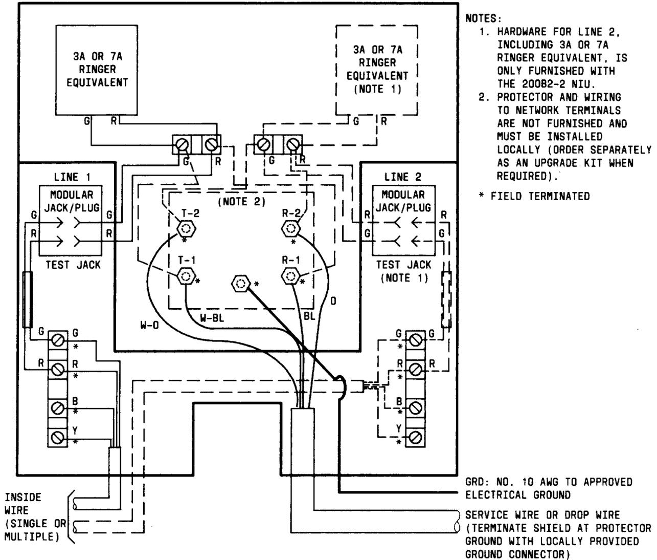
Fig. 6—200B1-1 and 200B2-2 NIU—Wiring Diagram
