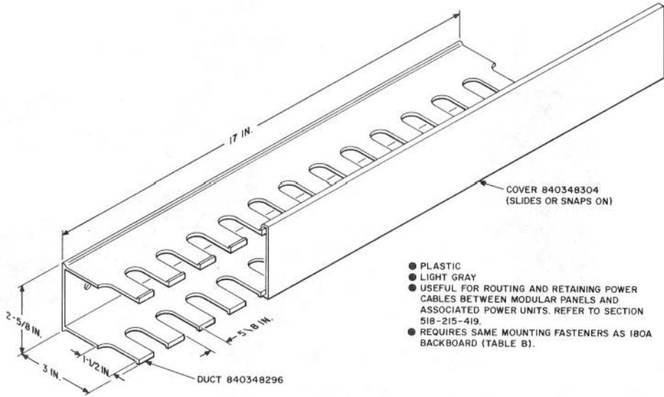
Fig. 42—Wiring Trough, 840348288
