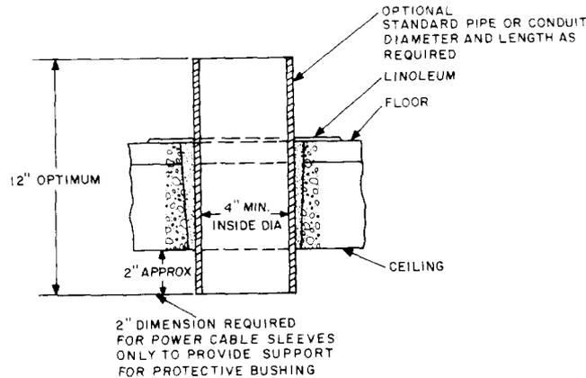
Fig. 2—Cable Sleeves
