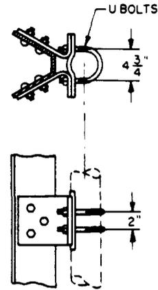
FIG 3B - PIPE BRACKET FOR KS-15852 ANTENNA AND KS-16320 REFLECTOR
