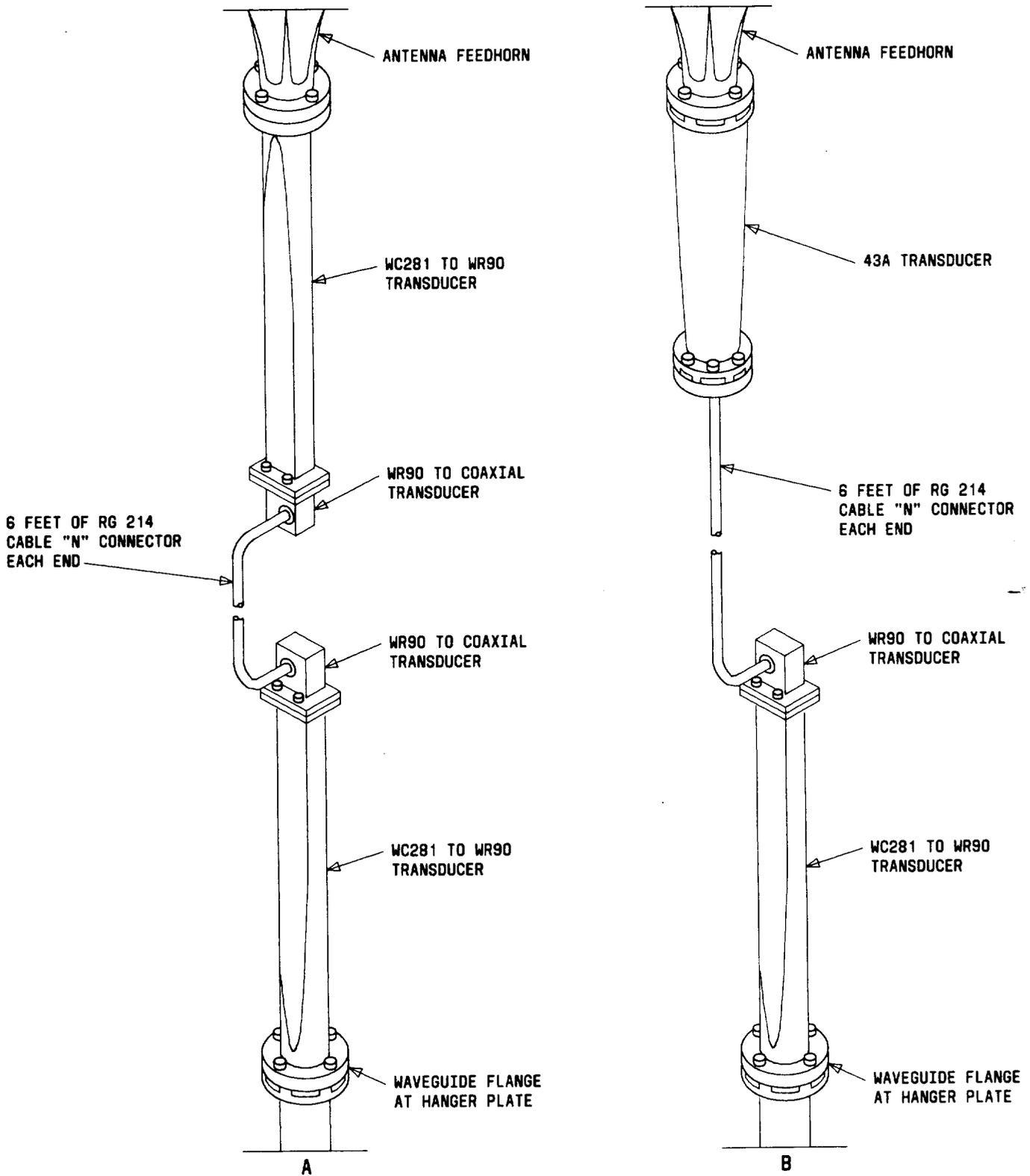
Fig. 11—Transducer Arrangement—11 GHz
