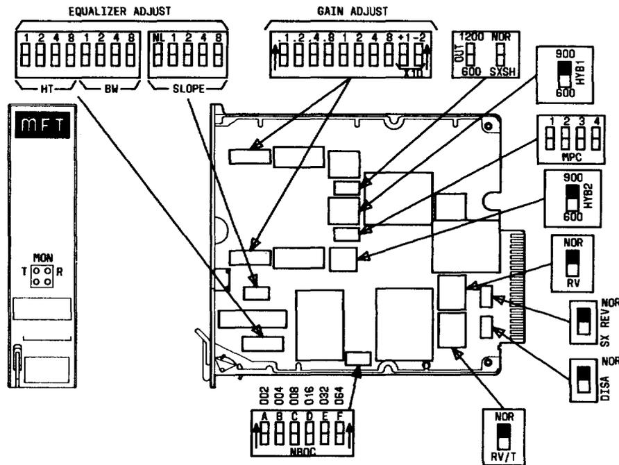
Fig. 2—J99343RA-1, L4 Component Layout
