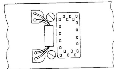
NETWORKS MOUNTED ON AK TYPE RELAYS (COMMON BATTERY OR GROUND)
