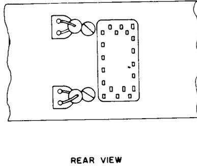
NETWORKS MOUNTED ON AK TYPE RELAYS (NON-COMMON BATTERY OR GROUND)
