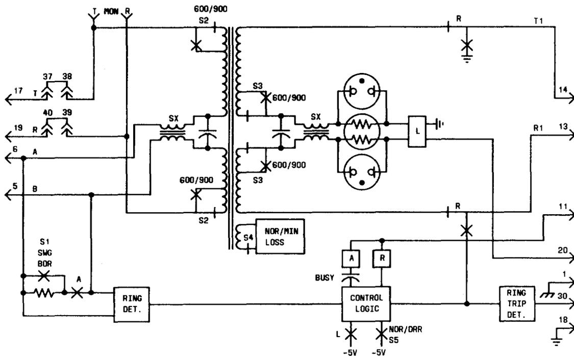
Fig. 1—J99343GA-1, L1 Block Diagram
