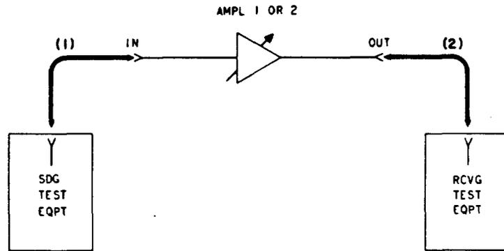
A-AMPLIFIER TEST CIRCUIT
