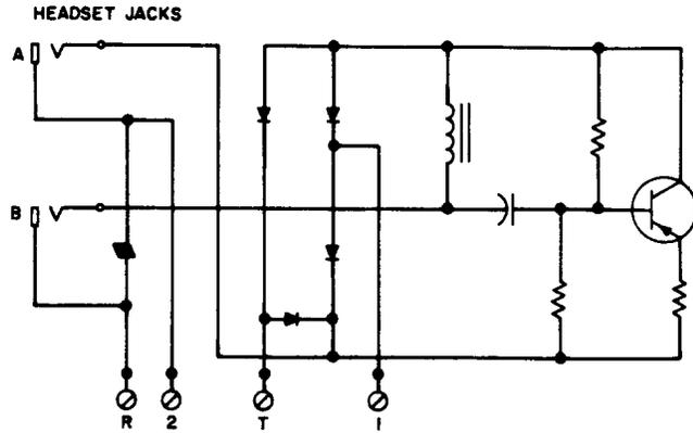
Fig. 4—242B Amplifier Schematic
