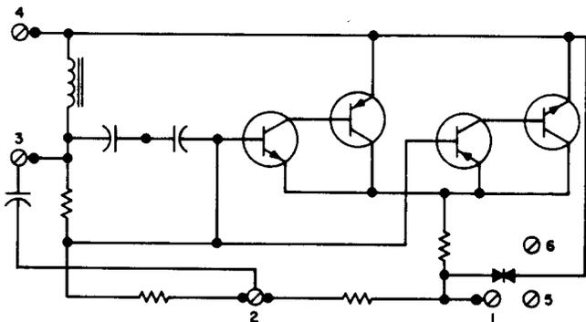
Fig. 3—241B Amplifier Schematic
