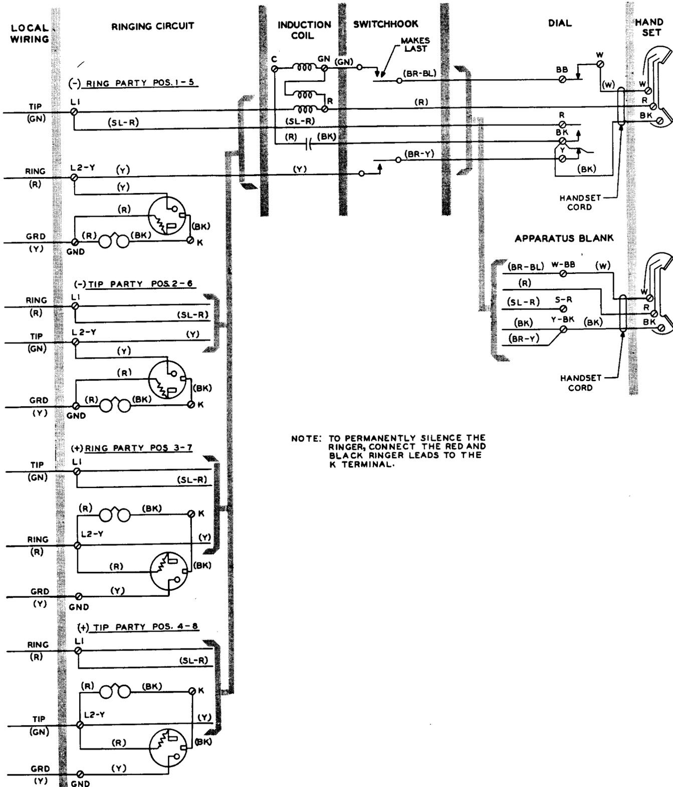
FIG. 3—356A,C CIRCUIT DIAGRAM
