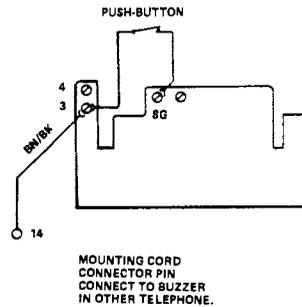
b. SIGNAL KEY WIRING, K564/K565
