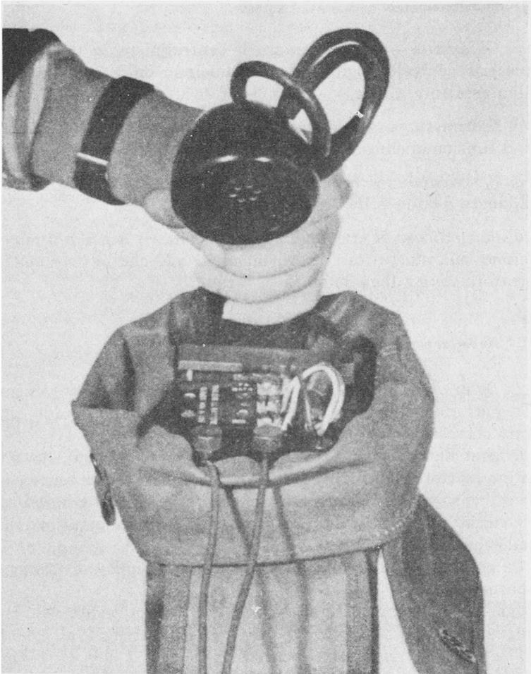
Fig. 16 - Rimessa in posto del microtelefono nel compartimento dell'involucro telefonico.
